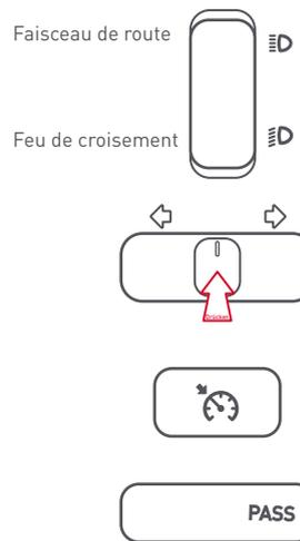
**Feux de route et feux de croisement:** Appuyez sur le haut de l'interrupteur pour allumer les feux de route ; appuyez sur le bas de l'interrupteur pour allumer les feux de croisement.
