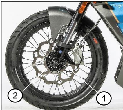
1. Capteur de roue avant
