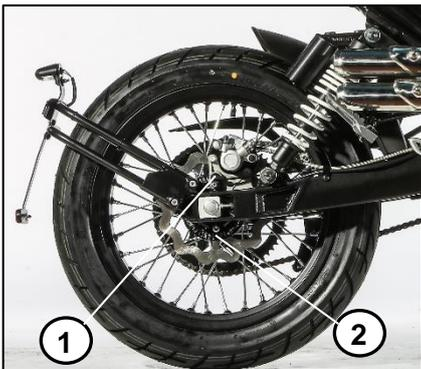
1. Capteur de roue arrière
