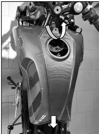
11. Retirez le couvercle du réservoir vers le haut et vers l'arrière du véhicule.
