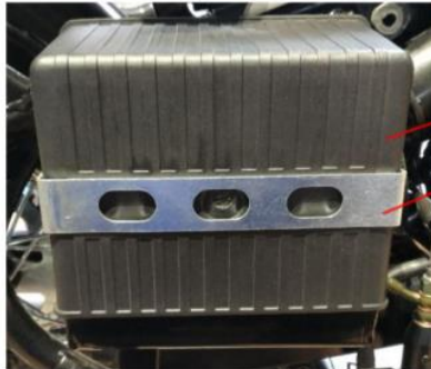
Boitier de protection batterie
