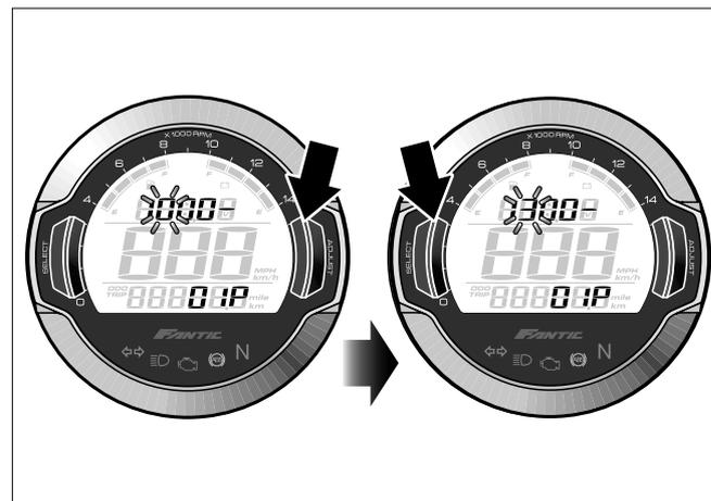
Pour modifier le réglage, appuyer sur la touche de réglage (« ADJUST »).
