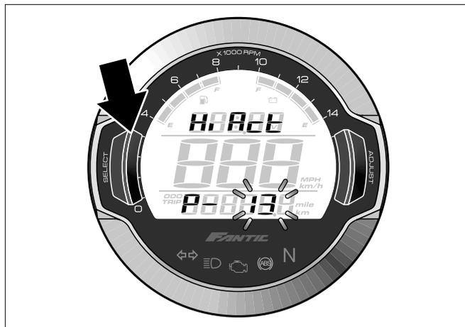
Appuyer sur la touche de réglage (« ADJUST ») pour sélectionner la forme d'onde correcte.
