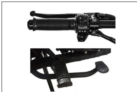
Les points de pivot du levier et de la pédale de frein doivent être lubrifiés aux intervalles indiqués dans le tableau d'entretien.
