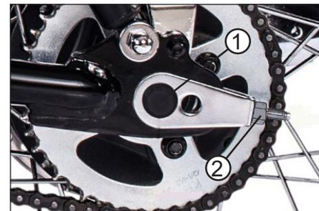
2. Desserrer l'écrou de l'axe de roue (1).
