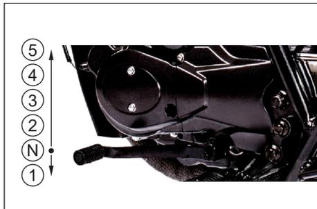
Le levier de vitesse international à engrenage constant à 5 vitesses a été choisi pour ce modèle de moto (cf l'illustration ci-contre pour l'utilisation). Le point mort est positionné entre la première et la seconde vitesse. Appuyez du pied sur le levier de vitesse pour passer de la première vitesse au point mort. Vous passerez à la vitesse supérieure en relevant le levier avec la pointe du pied. Vous descendrez d'une vitesse en appuyant sur le levier de vitesse du bout du pied.
