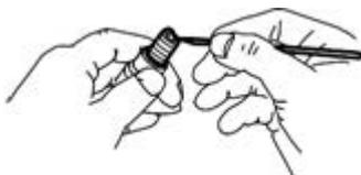
Nettoyez les dépôts sur les bougies d'allumage avec un fil de fer dur ou une aiguille en acier. Vérifiez ensuite l'écartement des électrodes de la bougie d'allumage à l'aide d'une jauge d'épaisseur et réglez l'écartement des électrodes.
