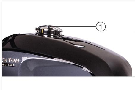
Retirez l'opercule de la serrure, et ouvrez le réservoir en tournant la clé du bouchon (1) dans le sens des aiguilles d'une montre. Pour fermer le bouchon du réservoir d'essence, alignez le symbole du bouchon avec la marque, enfoncez la clé et retirez-la. Enfin, remettez l'opercule pour couvrir la serrure du réservoir d'essence.
