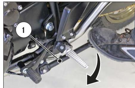
Contrôler la béquille latérale périodiquement (voir « Fiche d'entretien périodique »); vérifier que les ressorts ne soient pas endommagés et que la béquille latérale s'articule librement. Si la béquille latérale est bruyante, lubrifier le pivot (A) de fixation.
