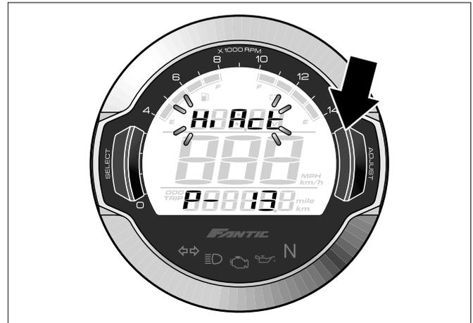
⚠ Vérifiez avec le moteur au ralenti si l'indicateur RPM indique une encoche et si, avec une légère rotation du gaz, il en indique deux. Dans ce cas, la configuration adoptée est correcte, sinon réessayez.
