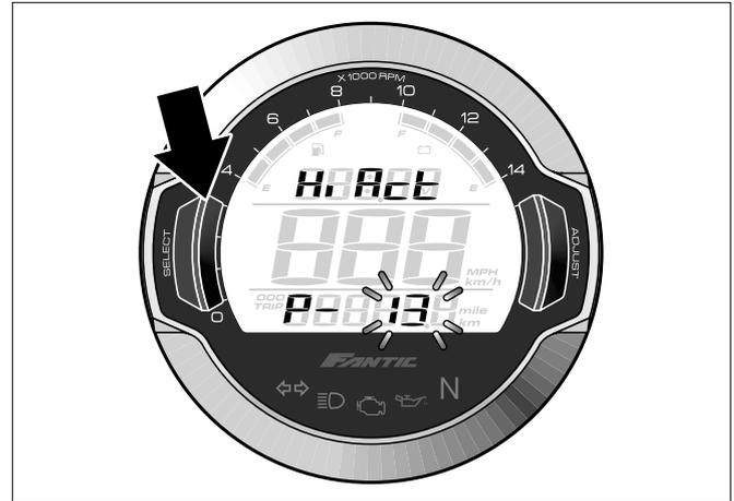
Appuyer sur la touche de réglage (« ADJUST ») pour sélectionner la forme d'onde correcte.
