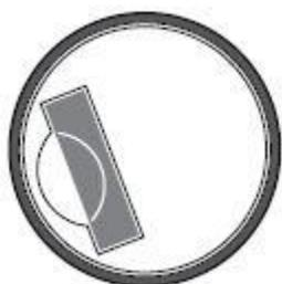
Le verrouillage de la direction est placé en bas à droite du tube de fourche. Lorsque vous l'utilisez, mettez le guidon vers la gauche et insérer la clé de contact dans le verrouillage de la direction et le tourner dans le sens des aiguilles d'une montre.
