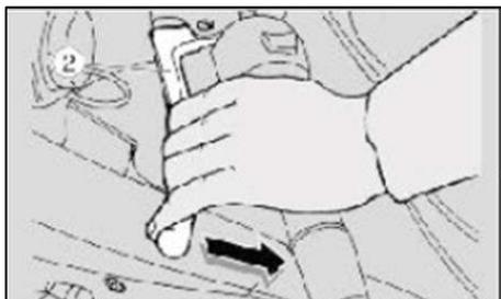
1. Avec la poignée des gaz (1) relâchée (Pos. **A**) et le moteur au ralenti, actionnez complètement le levier d'embrayage (2).
